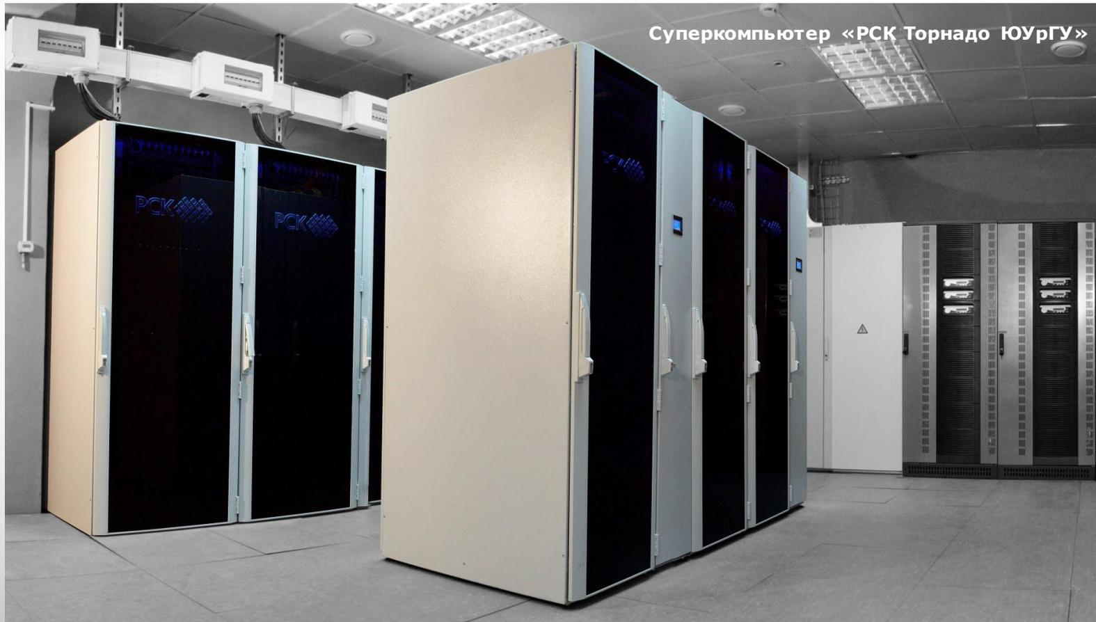
Современный суперкомпьютер – это совокупность большого числа (сотни или тысячи) высокопроизводительных серверов (узлов), соединённых друг с другом высокопроизводительным межсоединением (кластер) для достижения максимальной производительности путем распараллеливания вычислительных задач.
